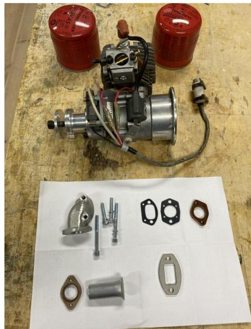
Der Motor erhält die übliche Vergaserumlenkung mit Ansaugtrichter für Rumpfansaugung. Die notwendigen Teile sind auf dem Foto auf der vorigen Seite abgebildet. Zusätzlich wird
