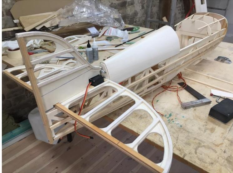
Das Leitwerk wird, ähnlich wie die untere Fläche, mit zwei Dübeln und einer M6 Nylonschraube am Rumpf befestigt. Dazu wird eine passende Einschlagmutter auf der Oberseite des Höhenleitwerks eingeklebt.
