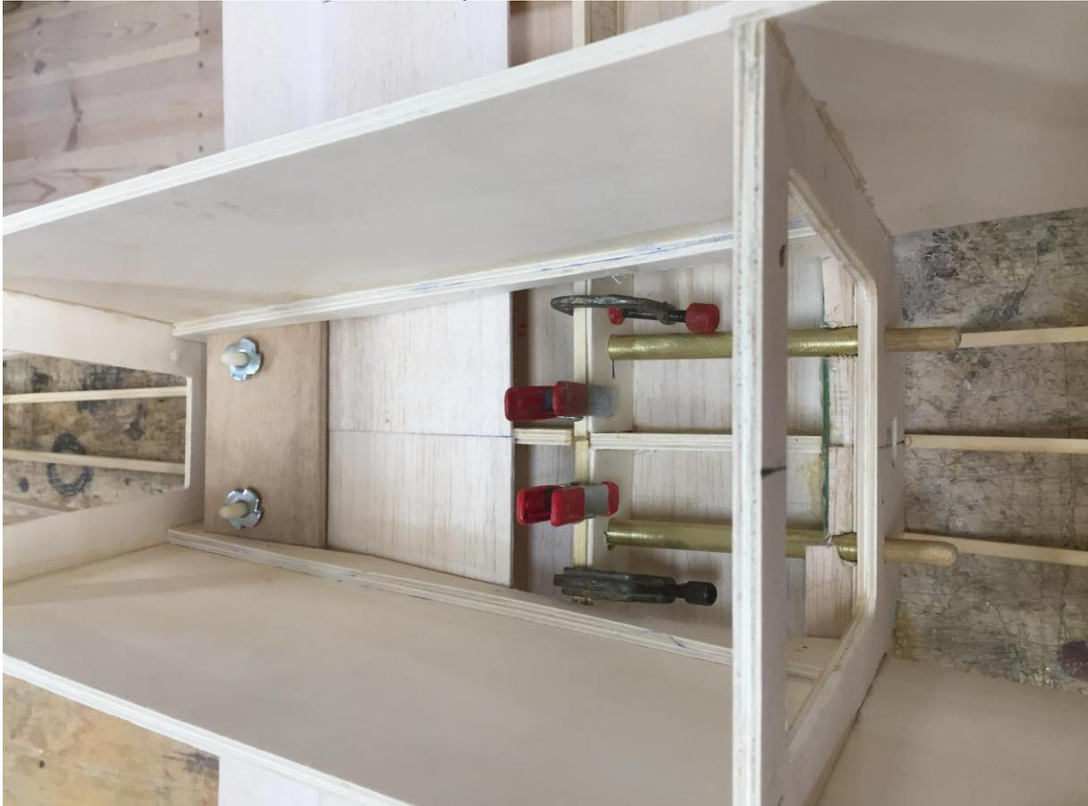
Da, wie oben beschrieben der Flächenausschnitt eh nicht ganz passt, habe ich diese Konstruktion aus Abfallholz der Frästeileplatten nach gebaut und passe so auch gleich die Anformung an die Fläche an. Auf Grund der Modellgröße benutze ich jedoch zwei M6 Schrauben und das Brett wurde aus 6mm Sperrholz gefertigt.
