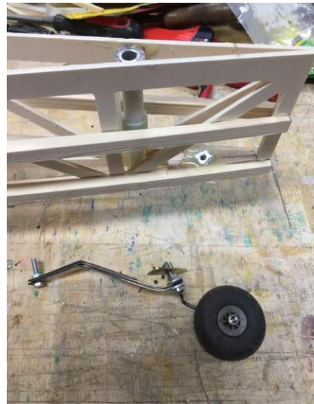
Im Rumpf wird die Schraube durch ein eingeklebtes GFK Rohr geführt und gehalten. Zusätzlich wurde noch ein Dübel im Holm des Seitenleitwerks ganz unten vorgesehen, um auch dieses sicher zu fixieren. Die Dübel sind aus 5mm Alu.
