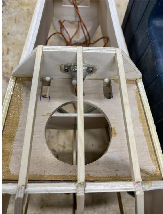
Die obere Fläche wurde soweit fertig beplankt und im Rumpf wurde ein stabiles Sperrholzbrett als Fahrwerksaufnahme mit Endfest 300 eingeklebt!
