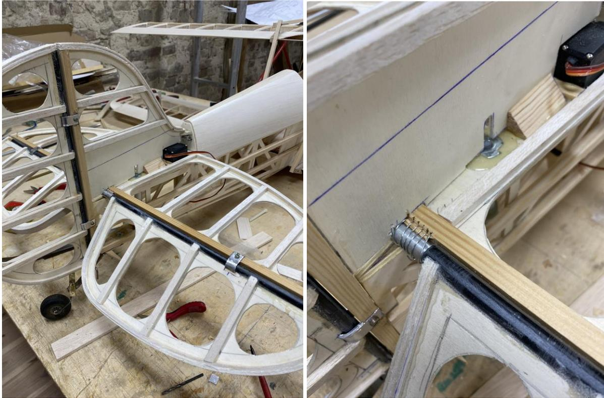
Das heißt: einige Laschen aus Flach- Alu, die das CFK Rohr umgreifen und so einen sicheren Halt bieten. Beim Höhenruder wurde in der Mitte ein ALU- Rohr mit Bindendraht an der Dämpfungfläche „vernäht“ und muss noch mit Uhu Endfest vergossen werden. Darin sind die Steuerflächen gelagert. An den äußeren Laschen werden die Halterungen für die Abspannungen mit verschraubt!
