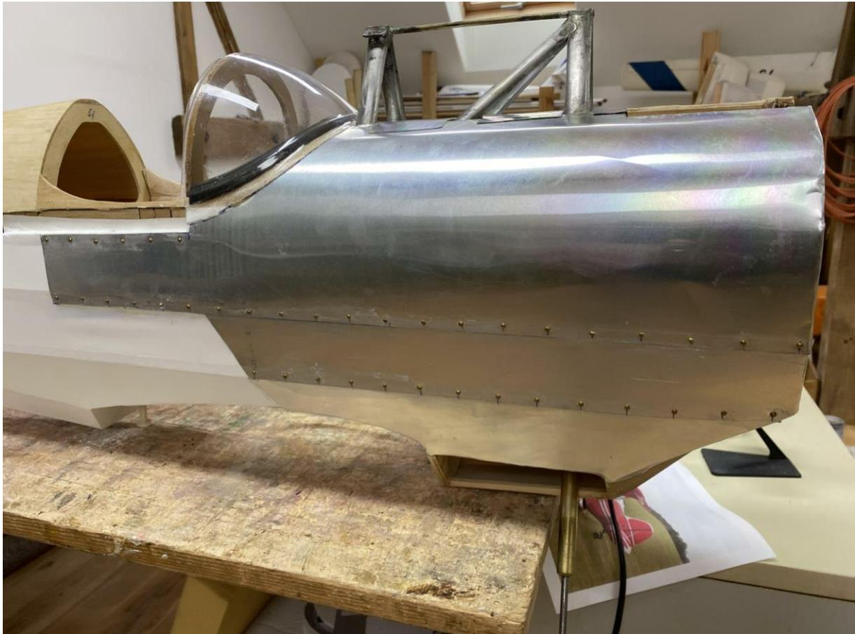
Die Bleche sind mit Pattex flächig verklebt und anschließend mit Messing-Nägeln „angenietet“. Dafür habe ich mit einem 0,8mm Bohrer vorgebohrt um die Abstände der Niete einzuhalten.
