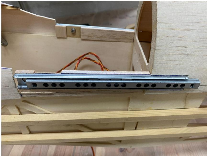
Das sind Schubladenlaufschienen, die ich hier zweckentfremdet habe. Damit lässt sich die Kabinenhaube originalgetreu öffnen, denn die Schalter der Empfangsanlage sind später in der Instrumententafel befestigt.
