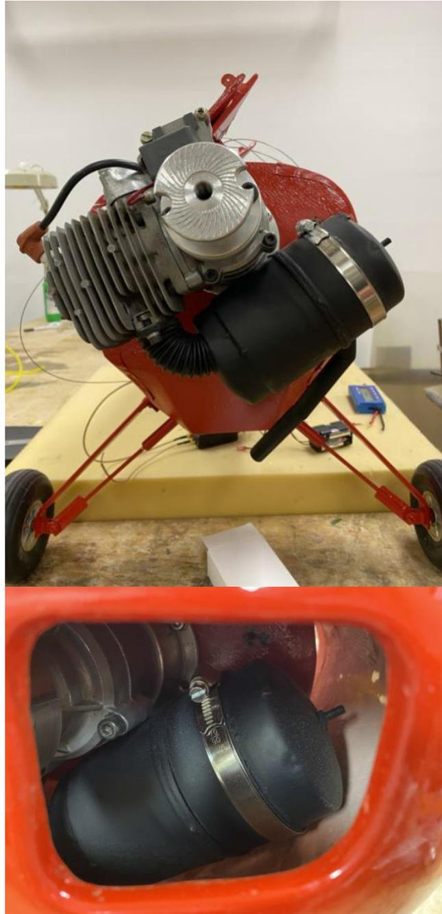
Der selbst gebaute 3-Kammerdämpfer passt komplett in die Motorhaube, sodass keine unschönen Durchbrüche nötig sind.
