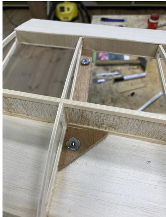
Die Krafteinleitung in die Flächen habe ich mit großen Sperrholzplatten erledigt, in die M3 Einschlagmuttern eingeklebt werden.
