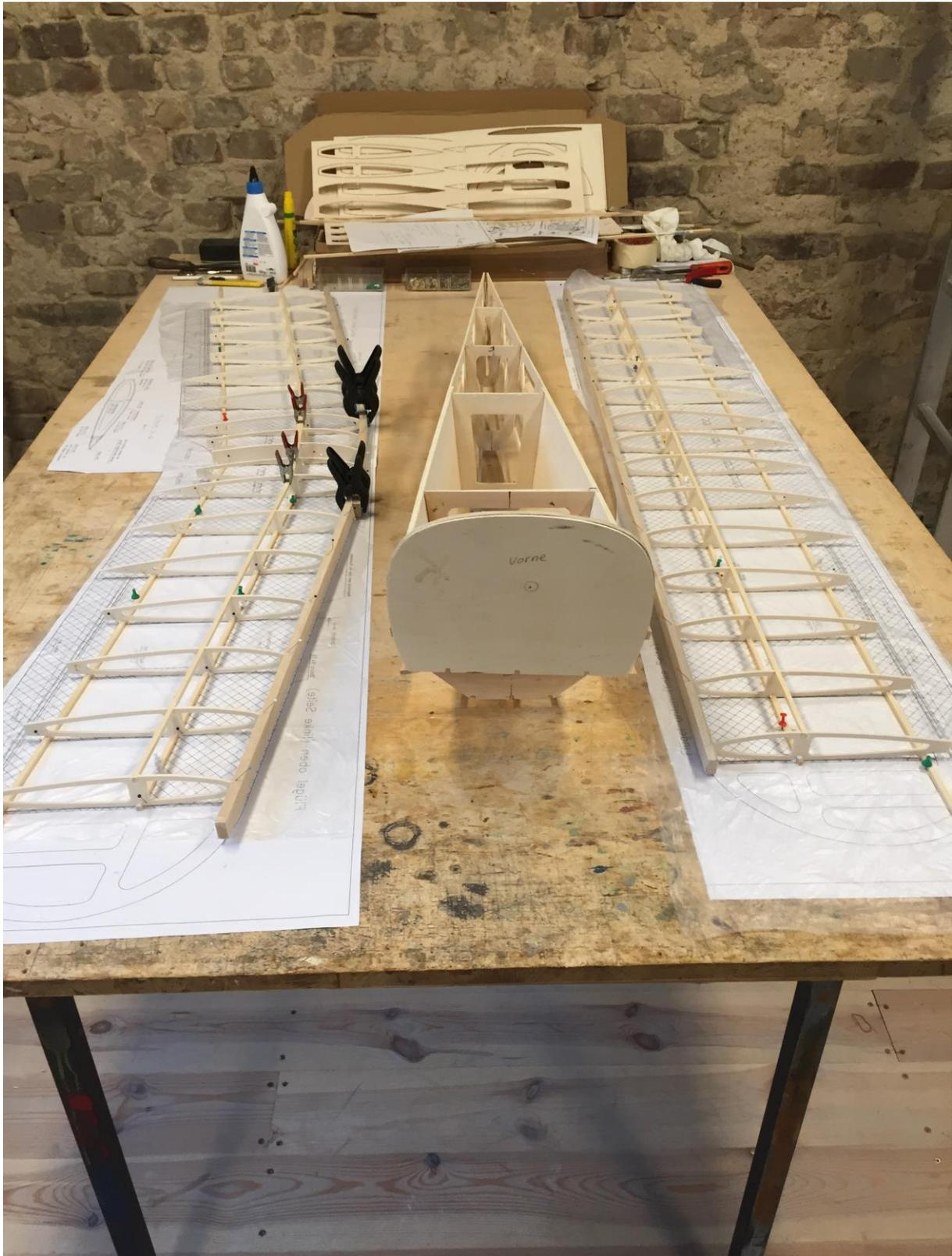
Hier trocknen die beiden Tragflächengerippe. Die untere Fläche wird erst nach dem Beplanken der Unterseite zu einem Stück mit V-Form verklebt. Man könnte die Flächen auch geteilt mit Steckung aufbauen, aber auf Grund der „geringen“ Spannweite von 175cm habe ich mich entschieden, das Gewicht dafür zu sparen. Ich habe keine Transportschwierigkeiten.
